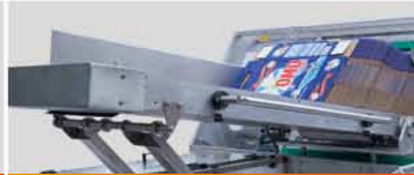
Uzatılmış Otomatik Beslemeli Kutu Magazini Extended Automatic Feeder Box Magazine
