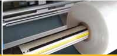
Havalı Şaft ile Kolay Folyo Değişimi Easy Folio Changeover with Air Shaft
